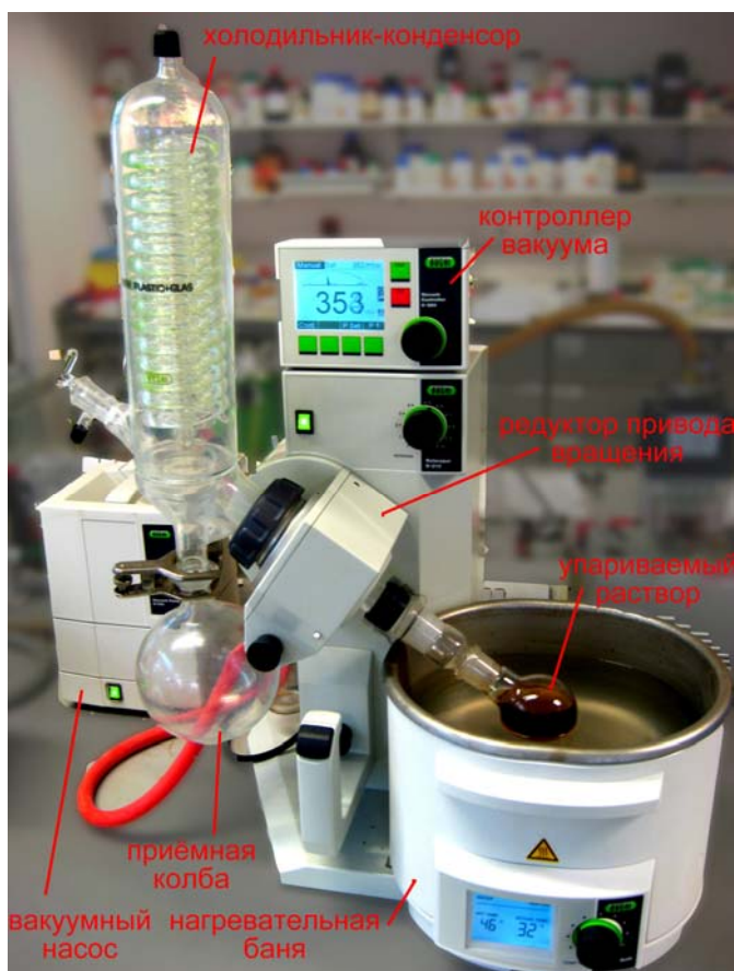
Рис. Ротационный испаритель: живъём (а) и принципиальная схема (б)
