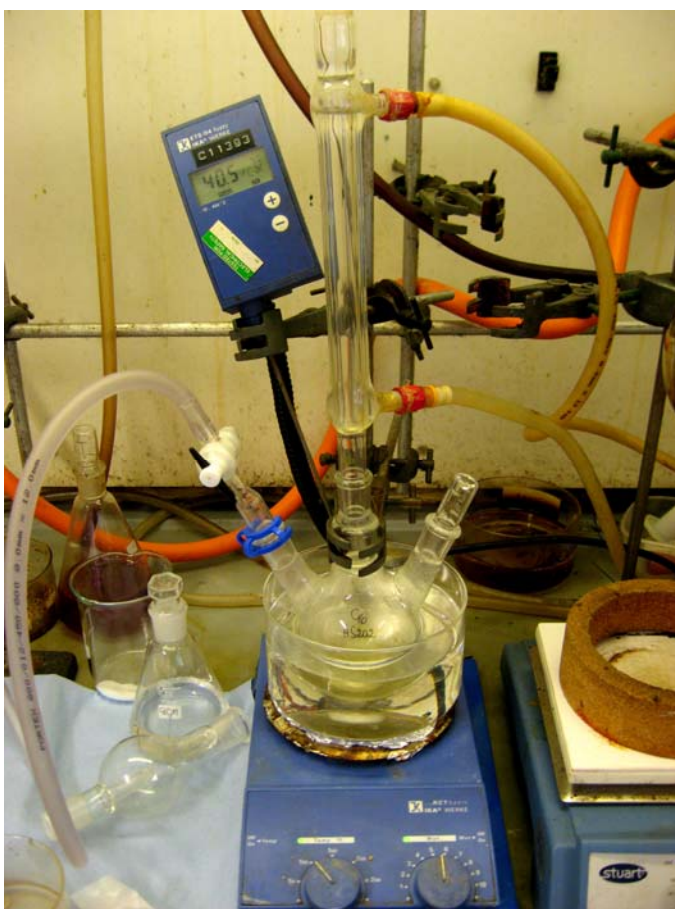
Рис. Установка для проведения реакции с нагревом и перемешиванием (а) фото (б) схема
